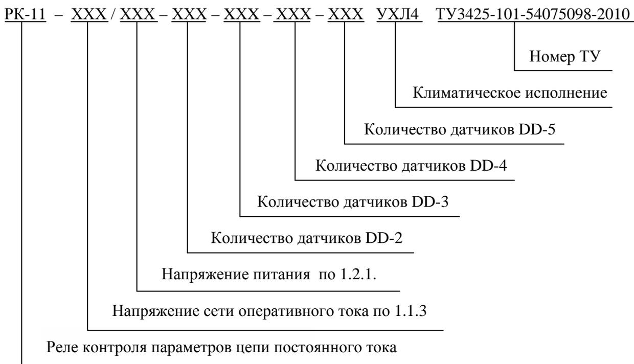
Пример записи обозначения реле при заказе или в документации другого изделия:
